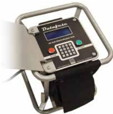
Gama de cajas de electrofundición Datafuse ACT
