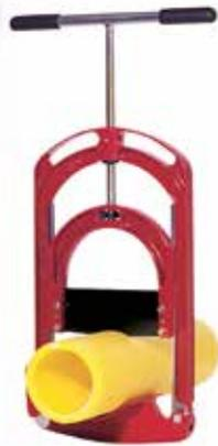
Hy-Ram es un agente en el Reino Unido para la gama de equipos Virax y Reed, incluidos los cortadores tipo guillotina. Estos presentan una viga transversal inferior con bisagras que se abre y permite que la cortadora se coloque en cualquier lugar a lo largo de la tubería. Los cortadores logran un corte recto y cuadrado y las cuchillas de corte son intercambiables y reemplazables.
