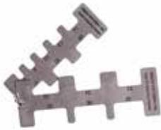
Los medidores de cordón son una forma rápida y sencilla de medir el ancho final del cordón de una soldadura a termofusión para garantizar que el ancho esté dentro de la tolerancia especificada.
